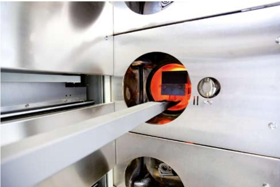
In solchen Diffusionsöfen werden Standardzellen mit Phosphor dotiert. In Zukunft wird es mehr Zellen aus n-Typ-Silizium geben, die eine höhere Effizienz erreichen können und mit Bor dotiert werden.
