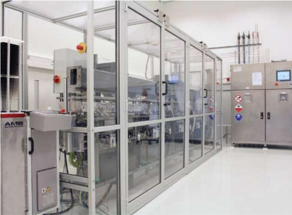
Mit dieser Maschine will die Firma Levitech Aluminiumoxid auf der Rückseite von Zellen sehr schnell abscheiden. Damit und mit einem besonderen Zellkonzept kann der Wirkungsgrad um rund 0,5 Prozentpunkte steigen.
