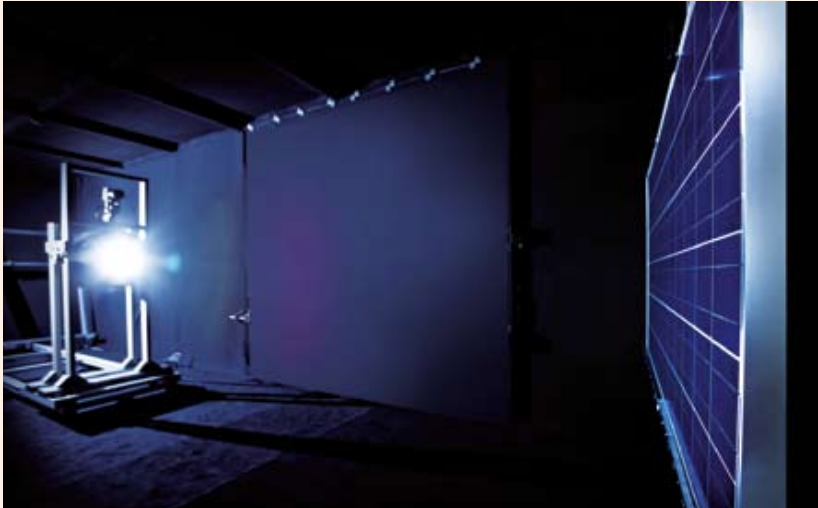
Mit dem Flasher überprüfen die Experten die Leistungsparameter.
